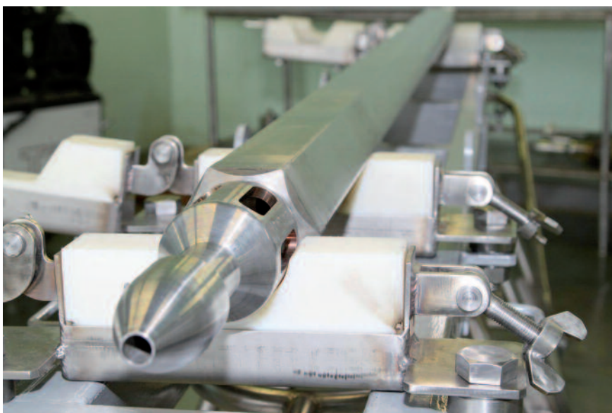
Zkušební kazeta s nitridovým palivem pro reaktor BREST-300 pro ozařovací zkoušky.
