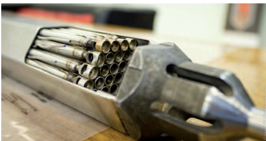
Horní konec makety palivové kazety pro rychlý reaktor chlazený sodíkem BOR-60 sloužící k výzkumným účelům.
