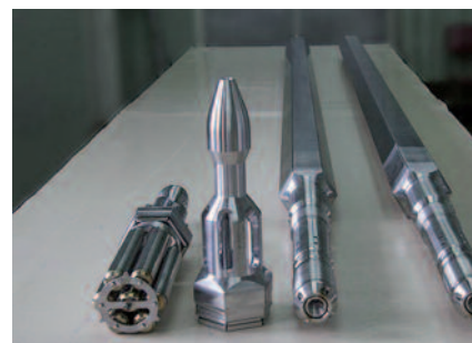
První palivové kazety se směsným palivem pro reaktor BN-800, které byly vyrobeny podnikem NIAR v Dimitrovgradu v rámci zkušební výroby, která v současnosti přechází na průmyslovou.
